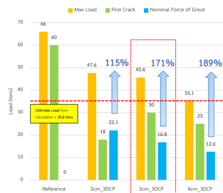
รูปที่ 5 แผนภูมิแสดงการเปรียบเทียบข้อมูลแรง Max load, First Crack และ Nominal Force Grout จากการทดสอบเสาแต่ละชนิด
