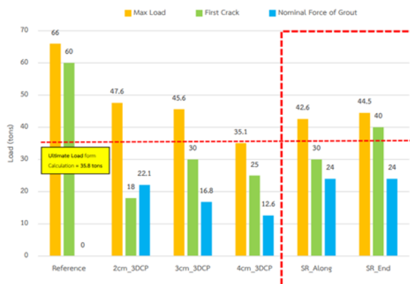
รูปที่ 7 แผนภูมิแสดงการเปรียบเทียบข้อมูลแรง Max load, First Crack และ Nominal Force Grout จากการทดสอบเสาแต่ละชนิด
